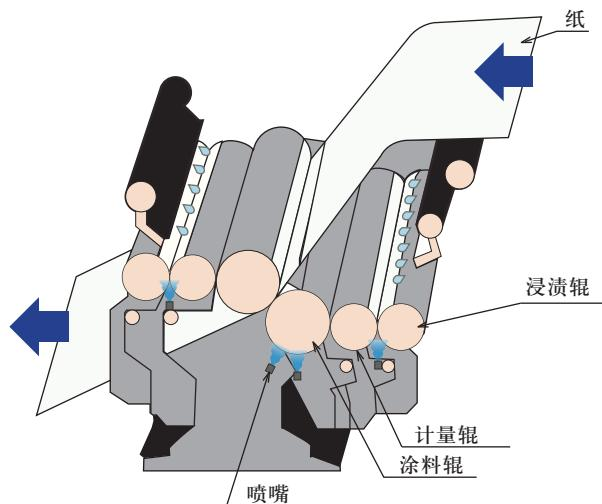
在辊筒的端面、端部,以细微雾状喷雾。
